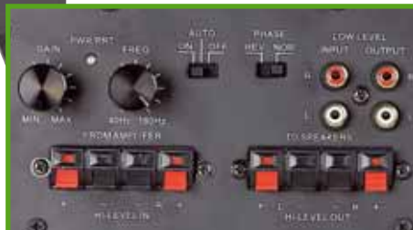
Die 150 Watt starke Endstufe sitzt direkt an der Rückseite des übersichtlich gestalteten Aktivterminals. Dieses ist mit je zwei Ein- und Ausgängen für den Nieder- und Hochpegelanschluss bestückt
