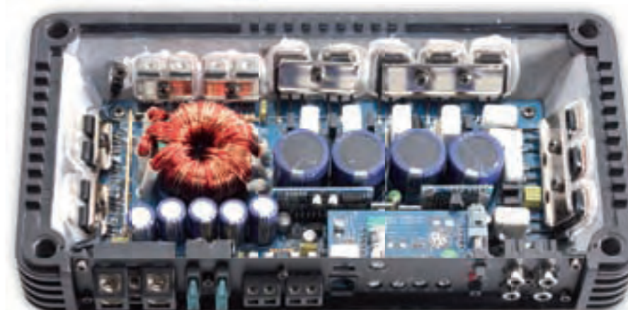
Schräglage: Die Leistungstransistoren sitzen auf den Flanken des massiven Guss-Kühlkörpers.
