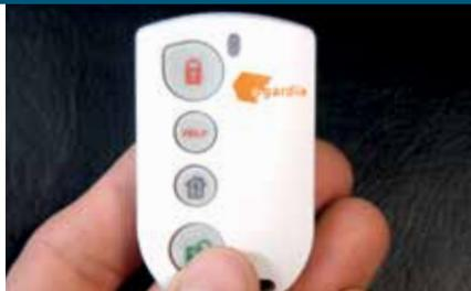
Über eine in der Regel zum Lieferumfang gehörende Fernbedienung lassen sich die Alarmanlagen auch von weitem scharf- bzw. unscharfschalten.
