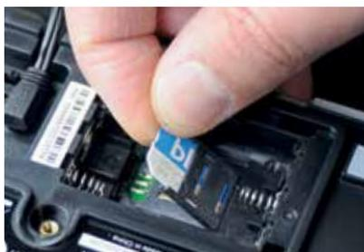
Zur Alarmweiterleitung muss je nach Ausführung eine SIM-Karte eingelegt oder ein kabelgebundener Anschluss mit dem Telefonnetz hergestellt werden.
