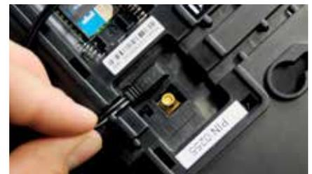
Netzanschluss und SIM-Karte sind hinter einer fest verschließbaren Abdeckung gut gegen Sabotage geschützt.
