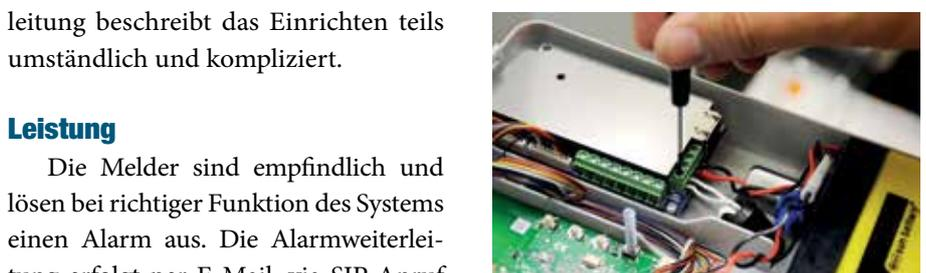
Die nicht eindeutig gekennzeichneten Kabel der Stromversorgung müssen mit der Platine verschraubt werden.
