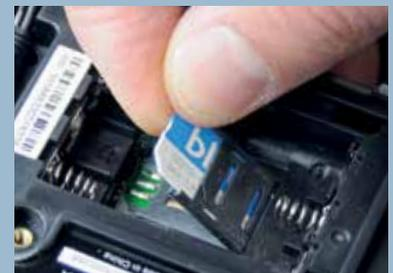
die SIM-PIN-Abfrage nicht deaktiviert, ist die SIM-Karte gesperrt und der Alarm kann nicht weitergeleitet werden. Zur Deaktivierung der PIN-Abfrage muss die SIM-Karte zunächst in ein geeignetes Mobiltelefon eingelegt werden. Nachdem die Karte durch die Eingabe der PIN entsperrt wurde, lässt sich die PIN-Abfrage nun durch die in den Telefoneinstellungen angegebenen Schritte deaktivieren.
