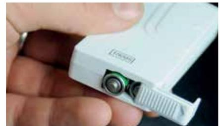
Zum Registrieren der mitgelieferten Melder an der Alarmzentrale genügt das Einsetzen der Batterien.
