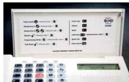
Bedienfeld und Display an der Alarmzentrale können unter einer Abdeckung versteckt werden.
