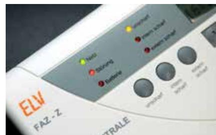
Status-LEDs und Programmtasten an der Alarmzentrale.
