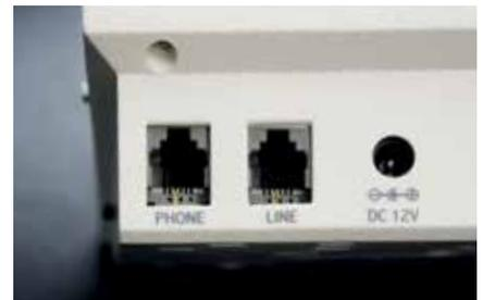
Telefonanschlüsse an der Rückseite der Alarmzentrale.
