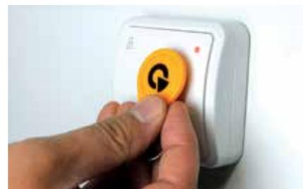
Scharf- und unscharfgeschaltet wird das System über einen praktischen RFID-Leser.
