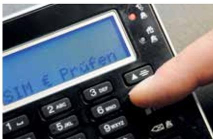
Die Einrichtung, Programmierung und Verwaltung erfolgt bei den meisten Geräten über Tasten und Display direkt an der Alarmzentrale.
