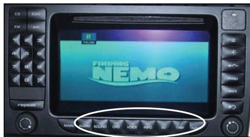
Um die zugefügte A/V Quelle auszuwählen, drücken Sie die A/V Taste, das Bild erscheint und Auto wird automatisch umschalten.
