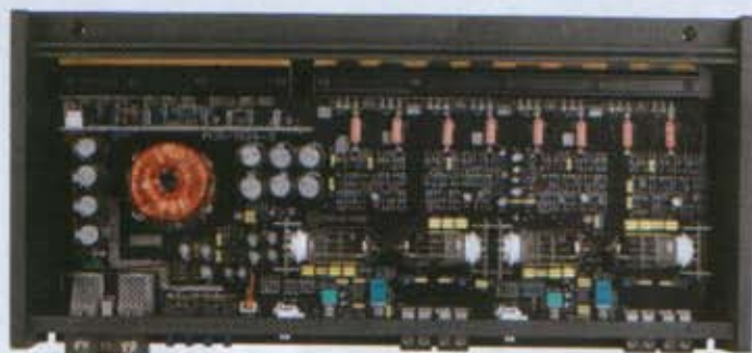
Sauber getrennter Aufbau: Unten sitzen die Doppeltrioden für die Vorverstärkung, oben erledigen Transistoren die Endverstärkung
