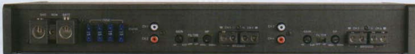
Die Terminals nehmen auch dickere Stromkabel auf, die Regler sind eindeutig für das Frontsystem ausgelegt
