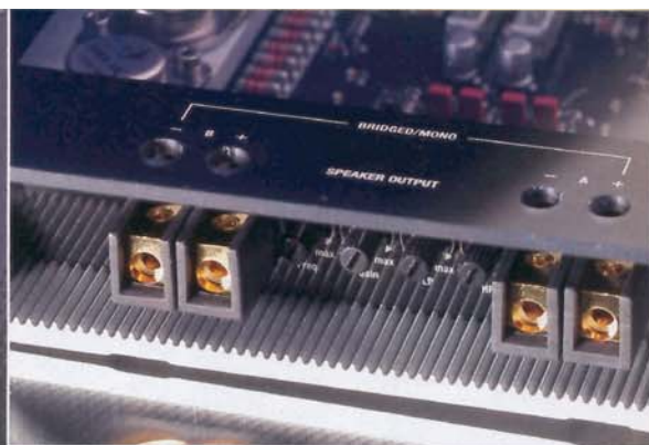
Regelwerk: Die Einstell-Potis der Frequenzweichen erlauben sehr weite Regelbereiche und machen die P200 fit für den Aktiv-Einsatz.
