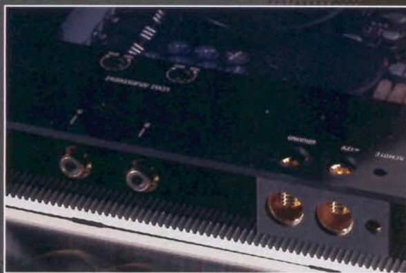
Da geht was: Die Stromklemmen der neuen Precision-Endstufen nehmen Stromkabel mit bis zu 50 Millimeter Durchmesser auf.
